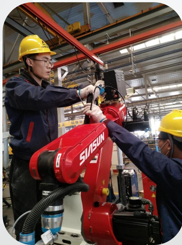
机器人安装调试
