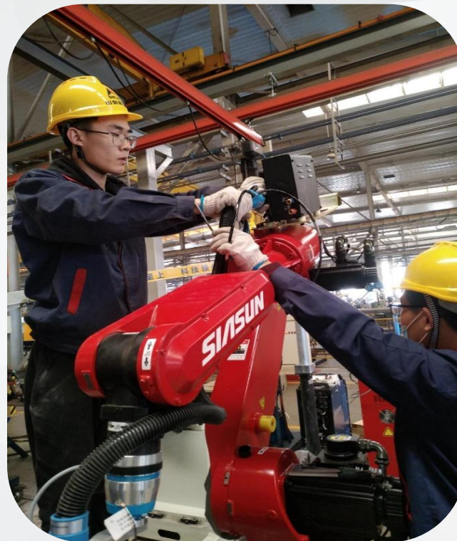
机器人安装调试
